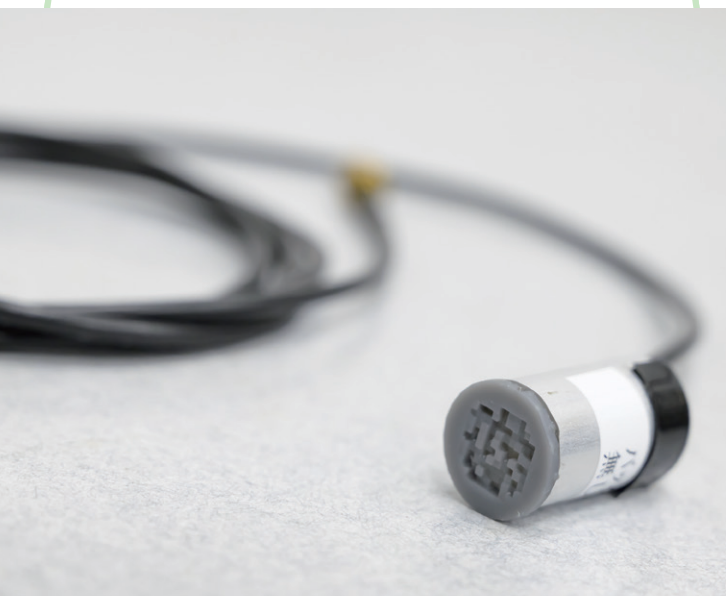
研究中の超音波センサーの試験モデル。モザイク模様に見えるものが「ランダムマスク」
