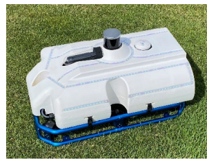
水上点検ロボット
