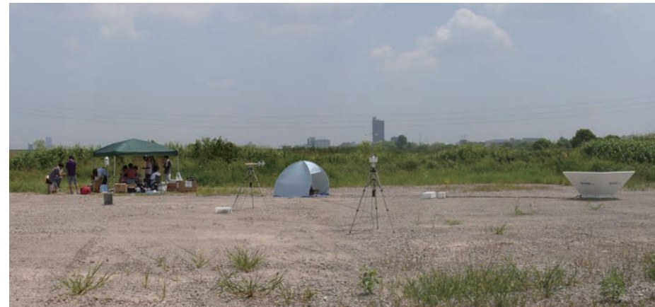
荒川河川敷での観測風景。風向き、気温、水蒸気量、気圧などを1台で測定する総合気象センサーや、熱流計、長短波放射計、上空の3次元的な風速を測定するドップラーソーダなど多様な観測機器で行う
