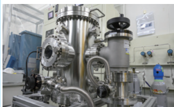
HiPIMSを用いて薄膜形成を行うための真空装置
