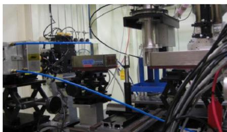
大型放射光施設を利用した実験。触媒反応中での触媒の局所構造・電子状態のその場観察
