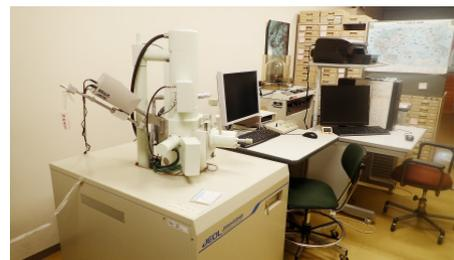
エネルギー分散型X線分析装置および走査顕微鏡。火山灰に含まれる火山ガラスの化学組成を測定できる
