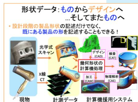
省人化と開発スピードの短縮をめざす中で、既に世界的な自動車メーカーでもX線CTを導入済み。事故で折れ曲がった後の形状の変位量なども計測可能
