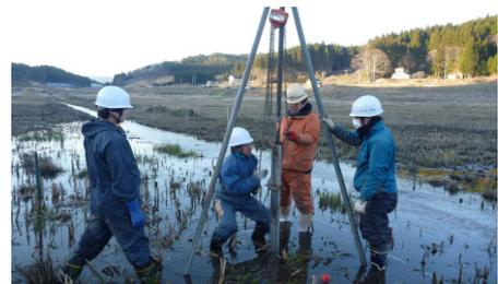
ハンディジョスライサーという掘削機器での掘削の様子。サンプリャーを引き上げている
