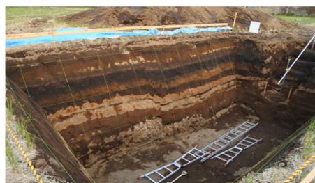
2016年熊本地震で出現した断層上で掘削した断層トレンチ。中央にほぼ垂直の断層がある
