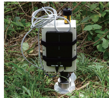
開発中の放射能濃度測定装置(地中に棒状の検出器が埋まっている状態)。軽く、小さく、持ち運びができ、その場で測定が可能。測定結果はインターネットで配信し、現在はPCで閲覧でき、スマートフォンでの閲覧も目指している
