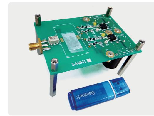
SAWデバイスをゲート駆動回路として用いた電力変換回路
