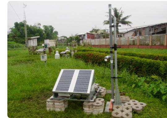
フィリピンに設置した雷観測装置
